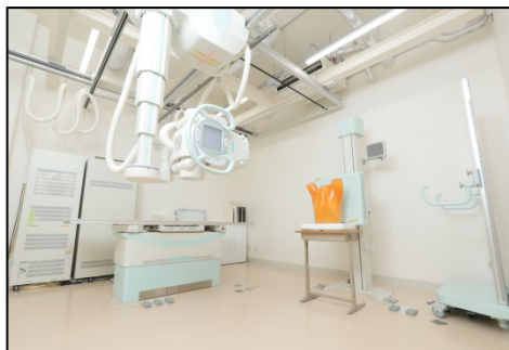
株式会社 島津製作所様寄贈 診断用X線装置 RADspeed Pro V4 一式
